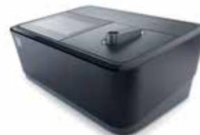
**Для сложных анализов** Prove 600 обладает широкими возможностями в компактном размере. Анализ проводится в разных прямоугольных кюветах до 100 мм, благодаря чему увеличена чувствительность некоторых методов. Прибор имеет отличное разрешение и чувствительность для анализа с тест-наборами, записи спектров и кинетики.
