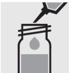
Добавьте 10 мл образца с помощью пипетки, закройте завинчивающейся крышкой и перемешайте.
