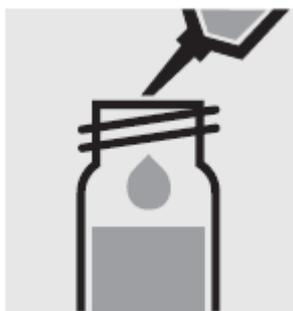
**Осторожно** добавьте 3.0 мл **истощенного контрольного образца** с помощью пипетки во вторую реакционную кювету, плотно закройте завинчивающейся крышкой и тщательно перемешайте. **Внимание, кювета нагревается!** (контрольная кювета)
