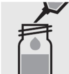
Добавьте 5.0 мл образца с помощью пипетки в реакционную кювету, закройте кювету завинчивающейся крышкой и перемешайте.
