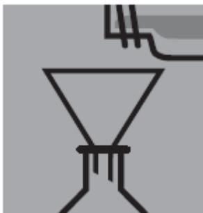
Отфильтруйте экстракт, **защищая от воздействия света**, через бумажный фильтр (“Blauband”) в мерный сосуд (для DIN 38412: 100 мл). Ополосните фильтр небольшим количеством этанола.
