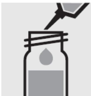
Добавьте 0.10 мл образца с помощью пипетки в реакционную кювету и закройте завинчивающейся крышкой, перемешайте.
