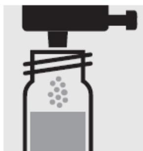
Добавьте 1 дозу  **$\text{NH}_4\text{-1K}$** , используя синий дозиметрический колпачок, закройте кювету завинчивающейся крышкой.
