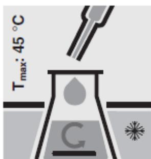
**Медленно** добавьте в каждую колбу Эрленмейера 25 мл **серной кислоты для определения ХПК** (каталожный номер 117048) с помощью стеклянной пипетки **при охлаждении и помешивании**.
