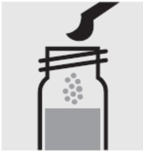
Добавьте 1 зеленую микроложку **НСНО-1К** в реакционную кювету, закройте завинчивающейся крышкой.
