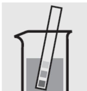
Проверьте pH образца, установленный диапазон: pH 1-10. При необходимости добавьте разведенный раствор гидроксида натрия или серной кислоты по каплям для регулировки значения pH.
