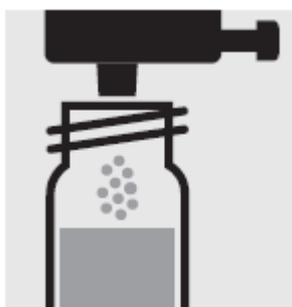
Добавьте 1 дозу **P-2К** с помощью синего дозиметрического колпачка, закройте кювету завинчивающейся крышкой.
