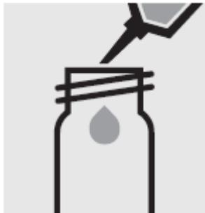
Добавьте с помощью пипетки 10 мл образца в тестовую пробирку (плоскодонные пробирки, каталожный номер 114902).
