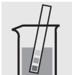
Проверьте рН образца, установленный диапазон: рН 3-10. При необходимости добавьте разведенный раствор гидроксида натрия или соляной кислоты по каплям для регулировки значения рН.
