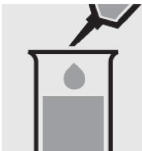
Добавьте с помощью пипетки 0.50 мл **Pb-1** в тестовую пробирку.
