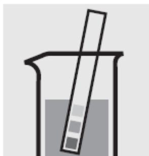
Проверьте pH образца, установленный диапазон: pH 2-5. При необходимости добавьте разведенный раствор гидроксида натрия или серной кислоты по каплям для регулировки значения pH.
