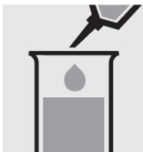
Добавьте с помощью пипетки 5.0 мл дистиллированной воды (рекомендуется использовать воду для анализа EMSURE<sup>®</sup>, каталожный номер 116754) во вторую тестовую пробирку (контроль).
