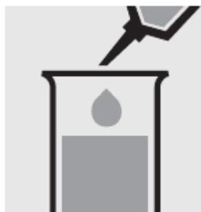
Добавьте с помощью пипетки 1.0 мл **Cd-1** в тестовую пробирку.
