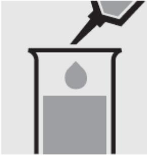
Добавьте 10 мл образца с помощью пипетки в тестовую пробирку.
