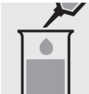
Добавьте с помощью пипетки 0.20 мл **Cl-1** в каждую из двух тестовых пробирок.
