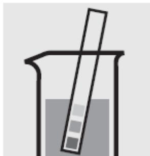
Проверьте pH образца, установленный диапазон: pH 0-10. При необходимости добавьте разведенный раствор серной кислоты по каплям для регулировки значения pH.
