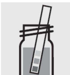
Проверьте pH образца, установленный диапазон: pH 12-13. При необходимости добавьте разведенный раствор гидроксида натрия по каплям для регулировки значения pH.
