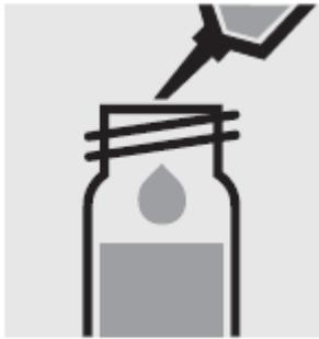
Осторожно добавьте 3.0 мл образца с помощью пипетки в реакционную кювету, плотно закройте завинчивающейся крышкой и тщательно перемешайте. **Внимание, кювета нагревается!**
