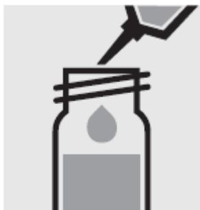
Добавьте с помощью пипетки 5.0 мл образца в реакционную кювету, закройте завинчивающейся крышкой и перемешайте.
