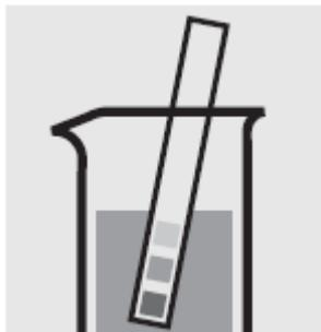
Проверьте pH образца, установленный диапазон: pH 3-9. При необходимости добавьте разведенный раствор гидроксида натрия или соляной кислоты по каплям для регулировки значения pH.
