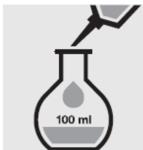
Добавьте с помощью пипетки 25 мл образца в 100-мл мерную колбу, наполните до метки дистиллированной водой и тщательно перемешайте.
