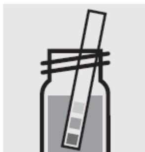
Проверьте рН образца, установленный диапазон: рН 3.0. При необходимости добавьте разведенный раствор гидроксида натрия или серной кислоты по каплям для регулировки значения рН.
