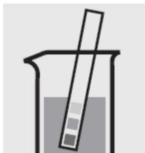
Проверьте pH образца, установленный диапазон: pH 0-13.
