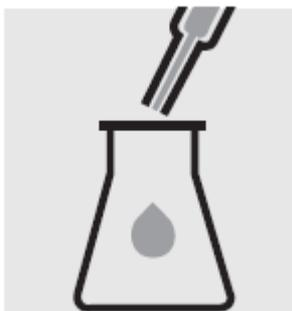
Добавьте с помощью стеклянной пипетки 20 мл дистиллированной воды (рекомендуется использовать воду для хроматографии LiChrosolv<sup>®</sup>, каталожный номер 115333) во вторую 300-мл коническую колбу Эрленмейера с горловиной NS 29/32.
