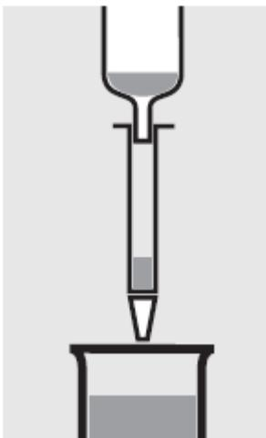
Удалите пробку из колонки и полностью пропустите через неё образец.
