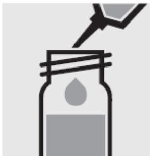
Добавьте 7.0 мл образца с помощью пипетки в реакционную кювету, закройте завинчивающейся крышкой и перемешайте.
