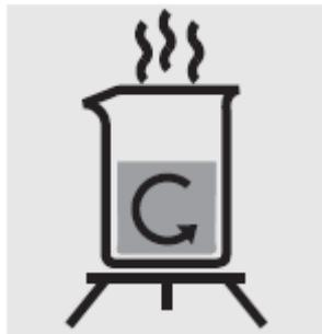
Расплавьте образец при 60-70°C и гомогенизируйте.
