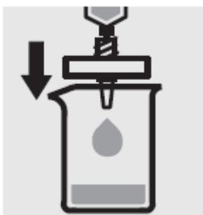
Отфильтруйте 10-20 мл **предварительно подготовленного раствора** через мембранный фильтр в чистый и сухой мерный стакан.
