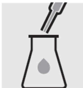
Добавьте с помощью стеклянной пипетки 20 мл образца в 300-мл коническую колбу Эрленмейера с горловиной NS 29/32.
