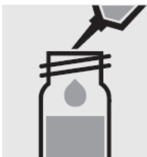
Добавьте с помощью пипетки 5.0 мл образца, закройте завинчивающейся крышкой и перемешайте.
