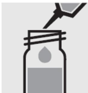
Добавьте 5.0 мл **предварительно подготовленного образца** с помощью пипетки, закройте завинчивающейся крышкой и перемешайте.
