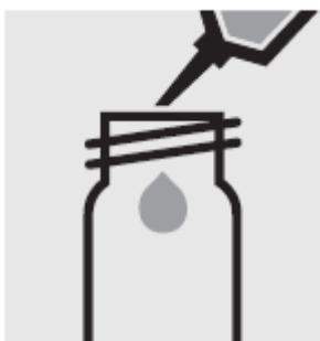
Добавьте с помощью пипетки 5.0 мл образца в реакционную кювету, закройте завинчивающейся крышкой.
