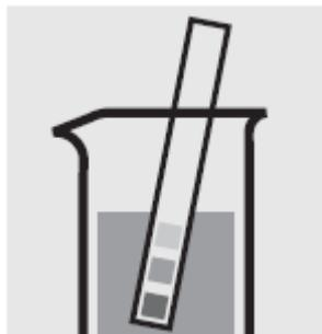
Проверьте pH образца, установленный диапазон: pH 6-8. При необходимости добавьте разведенный раствор гидроксида натрия или азотной кислоты по каплям для регулировки значения pH.
