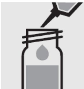
Добавьте с помощью пипетки 1.0 мл образца в реакционную кювету, закройте завинчивающейся крышкой и перемешайте.
