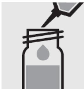
Добавьте с помощью пипетки 1.0 мл  **$\text{NO}_3\text{-1K}$**  в реакционную кювету, **не перемешивайте**.
