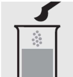
Добавьте 1 синюю микроложку **NH<sub>4</sub>-2** (из Spectroquant® Ammonium Test, каталожный номер 114752).
