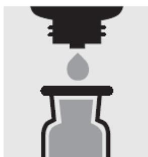
Добавьте 5 капель **BOD-1K** и затем 10 капель **BOD-2K**, закройте без пузырей воздуха и перемешайте в течение приблизительно 10 секунд.
