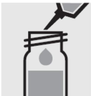
Добавьте с помощью пипетки 2.0 мл образца в тестовую пробирку с завинчивающейся крышкой.
