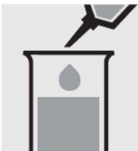
Добавьте с помощью пипетки 8.0 мл образца в тестовую пробирку.
