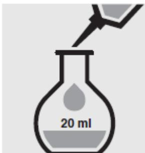
Доведите содержимое мерного сосуда до метки дистиллированной водой (рекомендуется вода для анализа EMSURE<sup>®</sup>, каталожный номер 116754) и тщательно перемешайте: это **предварительно подготовленный образец**.
