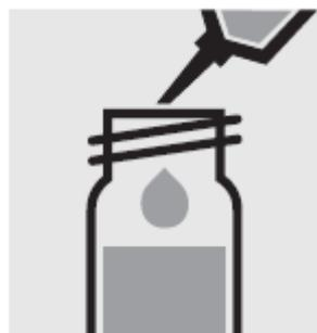
Добавьте с помощью пипетки 6.0 мл **Au-4**, закройте завинчивающейся крышкой.
