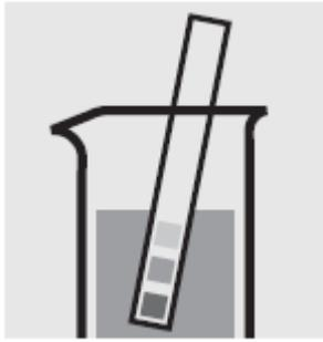
Проверьте pH образца и запишите.
