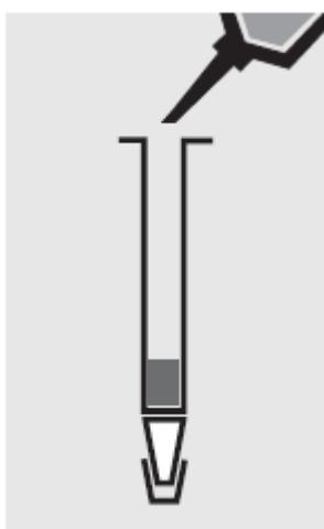
Закройте нижний конец колонки пробкой. Добавьте 1 мл **АОХ-3** в колонку. Закройте верхний конец колонки крышкой и встряхните, чтобы удалить пузырьки воздуха. Удалите пробку с верхнего конца колонки и заполните колонку до краев **АОХ-3**.
