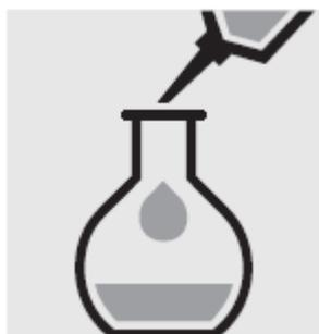
Добавьте 1.0 мл **реагента 3** с помощью пипетки, наполните до метки дистиллированной водой и тщательно перемешайте.
