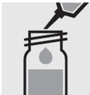
**Осторожно** добавьте 2.0 мл образца с помощью пипетки в реакционную кювету, плотно закройте завинчивающейся крышкой и тщательно перемешайте. **Внимание, кювета нагревается!**
