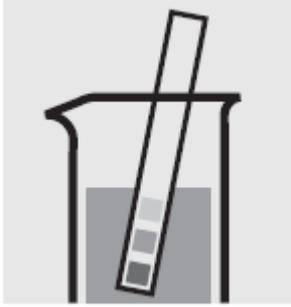
Проверьте pH образца, установленный диапазон: pH 2-11. При необходимости добавьте разведенный раствор гидроксида натрия или серной кислоты по каплям для регулировки значения pH.
