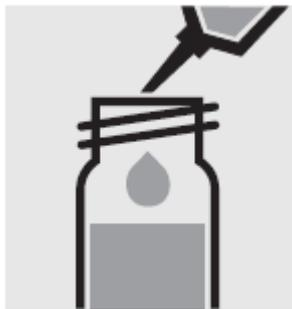
Добавьте с помощью пипетки 8.0 мл образца, закройте завинчивающейся крышкой.
