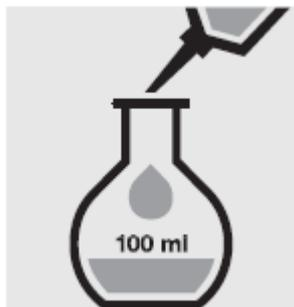
Добавьте 5.0 мл образца в 100-мл мерную колбу, наполните до метки дистиллированной водой и тщательно перемешайте.
