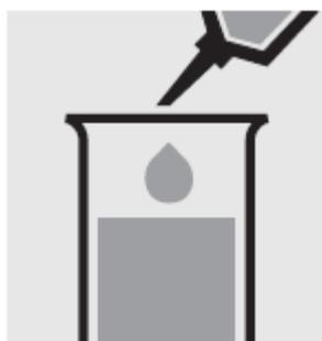
Добавьте 5.0 мл образца с помощью пипетки в тестовую пробирку.
