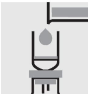
Отфильтруйте образец через подходящий фильтр (например, стекловолоконный фильтр).
