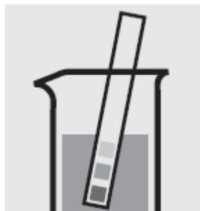
Проверьте pH образца, установленный диапазон: pH 2.0 – 2.5. При необходимости добавьте разведенный раствор гидроксида натрия или серной кислоты по каплям для регулировки значения pH.
