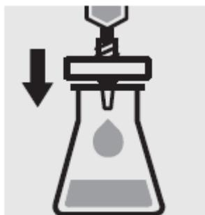
Отфильтруйте раствор образца через мембранный фильтр с диаметром пор 0.45 мкм.
