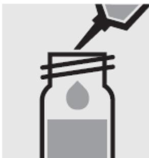
Добавьте 1.0 мл образца с помощью пипетки, закройте кювету завинчивающейся крышкой и перемешайте.
