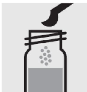
Добавьте 1 серую микроложку **Zn-5**, закройте тестовую пробирку завинчивающейся крышкой и растворите твердое вещество.
