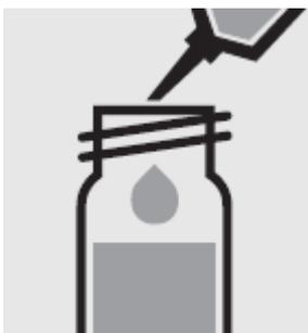
Добавьте с помощью пипетки 5.0 мл образца в реакционную кювету, закройте завинчивающейся крышкой и перемешайте.
