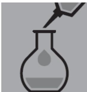
Доведите содержимое мерного сосуда до метки этанолом, **на протяжении всего процесса защищайте сосуд от воздействия света!**
