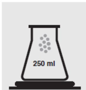
Взвесьте **5.0 г** гомогенизированного образца, с точностью навески до 0.1 г, или **10/30/50 г** гомогенизированного образца, с точностью навески до 1 г, в зависимости от предполагаемой насыщенности цвета.
