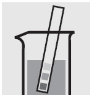
Проверьте pH образца, установленный диапазон: pH 2-10. При необходимости добавьте разведенный раствор серной кислоты по каплям для регулировки значения pH.
