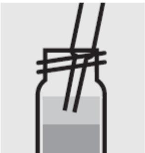
Отберите прозрачную верхнюю фазу из пробирки с помощью пипетки.
