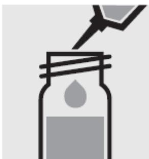
Добавьте 0.50 мл образца с помощью пипетки в реакционную кювету и закройте завинчивающейся крышкой, перемешайте.
