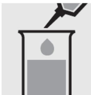
Добавьте с помощью пипетки 0.10 мл образца в тестовую пробирку.
