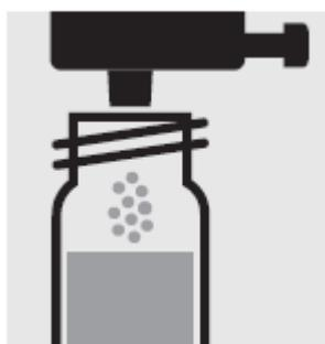
Добавьте 1 дозу **P-1К** с помощью зеленого дозиметрического колпачка, закройте кювету завинчивающейся крышкой.
