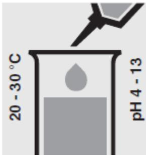
Добавьте 5.0 мл образца в тестовую пробирку. При необходимости, добавьте разведенный раствор гидроксида натрия или серной кислоты по каплям для регулировки значения pH и доведите образец до необходимой температуры.
