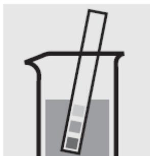
Проверьте pH образца, установленный диапазон: pH 1-9. При необходимости добавьте разведенный раствор гидроксида натрия или серной кислоты по каплям для регулировки значения pH.
