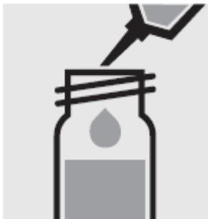
Добавьте 6.0 мл образца с помощью пипетки в реакционную кювету, закройте завинчивающейся крышкой и перемешайте.
