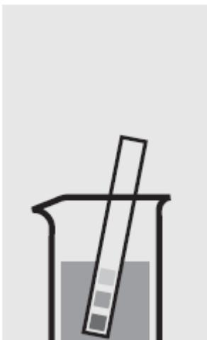
Проверьте pH образца, установленный диапазон: pH 6-7. При необходимости добавьте разведенный раствор гидроксида натрия или азотной кислоты по каплям для регулировки значения pH.
