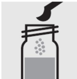
Добавьте 1 серую микроложку **Pb-2К** в кювету после измерения, закройте завинчивающейся крышкой.
