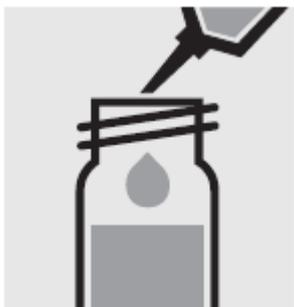
Добавьте 5.0 мл образца с помощью пипетки в реакционную кювету, закройте завинчивающейся крышкой и перемешайте.
