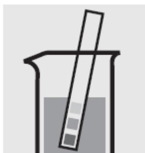
Проверьте pH образца, установленный диапазон: pH 3-8. При необходимости добавьте разведенный раствор гидроксида натрия или серной кислоты по каплям для регулировки значения pH.
