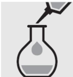
Добавьте с помощью пипетки 4.0 мл разведенного образца в 100-мл мерную колбу, наполните до метки дистиллированной водой и тщательно перемешайте.
