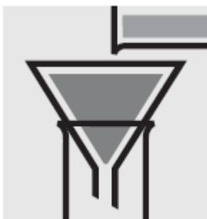
Если присутствуют примеси, отфильтруйте образец с помощью фильтровальной бумаги.
