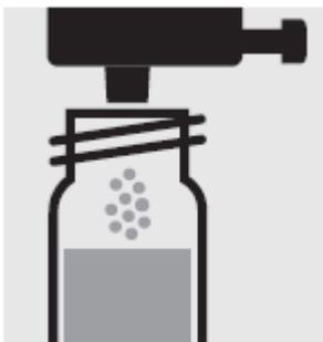
Добавьте 1 дозу **Р-3К** с помощью синего дозиметрического колпачка, закройте кювету завинчивающейся крышкой.
