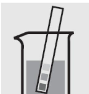
Проверьте pH образца, установленный диапазон: pH 3-11. При необходимости добавьте разведенный аммиачный раствор или азотной кислоты по каплям для регулировки значения pH.
