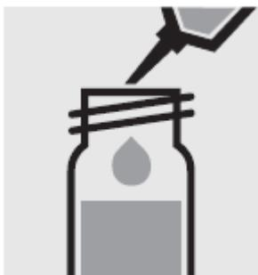
Добавьте с помощью пипетки 5.0 мл образца в реакцию кювету, закройте завинчивающейся крышкой и перемешайте.
