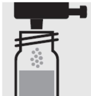
Добавьте 1 дозу **NH<sub>4</sub>-1К**, используя синий дозиметрический колпачок, закройте кювету завинчивающейся крышкой.
