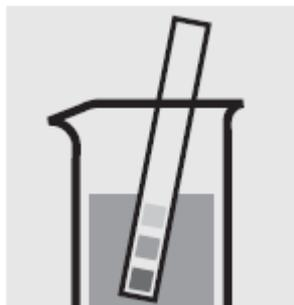
Проверьте pH образца, установленный диапазон: pH 1-9. При необходимости добавьте разведенный раствор соляной кислоты по каплям для регулировки pH.
