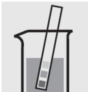
Проверьте pH образца, установленный диапазон: pH 6-8. При необходимости добавьте разведенный раствор гидроксида натрия или серной кислоты по каплям для регулировки значения pH.
