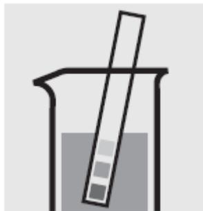
Проверьте pH образца, установленный диапазон: pH 4.5 -8.0. При необходимости добавьте разведенный раствор гидроксида натрия или серной кислоты по каплям для регулировки значения pH.
