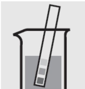
Проверьте pH образца, установленный диапазон: pH 1-12. При необходимости добавьте разведенный аммиачный раствор или азотной кислоты по каплям для регулировки значения pH.
