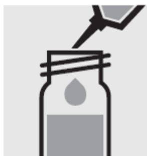
Добавьте 4.0 мл образца с помощью пипетки в реакцию кювету, закройте кювету завинчивающейся крышкой.
