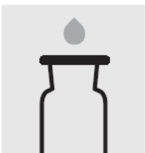
Заполните 2 кислородные реакционные емкости **предварительно подготовленным образцом** и 2 стеклянными частицами до отказа. Закройте ёмкости без пузырьков воздуха притертыми стеклянными пробками.
