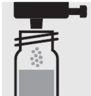
Добавьте 1 дозу **CN-1K** с использованием зеленого дозиметрического колпачка, закройте кювету завинчивающейся крышкой.
