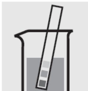
Проверьте рН образца, установленный диапазон: рН 3-9. При необходимости добавьте разведенный раствор гидроксида натрия или соляной кислоты по каплям для регулировки значения рН.
