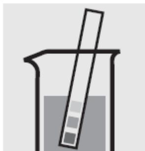
Проверьте pH образца, установленный диапазон: pH 2-8. При необходимости добавьте разведенный раствор гидроксида натрия или азотной кислоты по каплям для регулировки значения pH.
