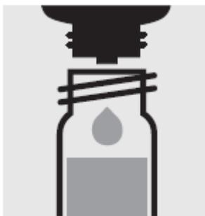
Добавьте 2 капли  $\text{Cl}_2\text{-3}$ , закройте завинчивающейся крышкой и перемешайте.
