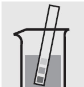
Проверьте рН образца, установленный диапазон: рН 3-11. При необходимости добавьте разведенный аммиачный раствор или азотной кислоты по каплям для регулировки значения рН.
