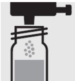
Добавьте 1 дозу **Fe-1К** с использованием синего дозиметрического колпачка, закройте реакцию кювету завинчивающейся крышкой.
