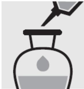
Добавьте с помощью пипетки 200 мл образца в делительную воронку.
