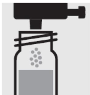
Добавьте 1 дозу **CN-1** с использованием зеленого дозиметрического колпачка, закройте кювету завинчивающейся крышкой.
