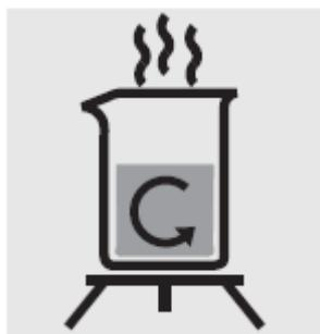
Выпарьте на варочной панели 200 мл раствора образца в стеклянном аналитическом стакане почти досуха.
