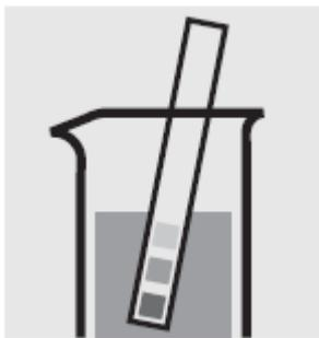
Проверьте pH образца, установленный диапазон: pH 3-6. При необходимости добавьте разведенный аммиачный раствор или азотной кислоты по каплям для регулировки значения pH.
