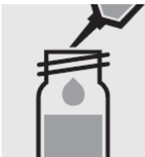
Добавьте с помощью пипетки 1.0 мл образца в реакцию кювету, закройте завинчивающейся крышкой и перемешайте.
