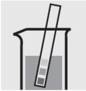
Проверьте pH образца, установленный диапазон: pH 1-13.
