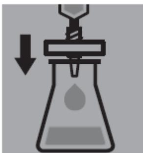
Отфильтруйте экстракт, **защищая от воздействия света**, через подходящий фильтр.
