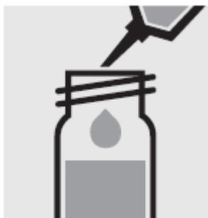
Добавьте 10 мл дистиллированной воды с помощью пипетки во вторую реакционную кювету, закройте завинчивающейся крышкой и перемешайте (контроль).
