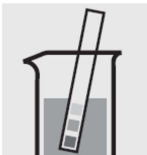
Проверьте рН образца, установленный диапазон: рН 4-13. При необходимости добавьте разведенный раствор гидроксида натрия или серной кислоты по каплям для регулировки значения рН.
