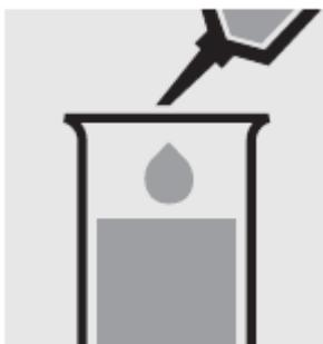
Добавьте с помощью пипетки 8.0 мл образца в тестовую пробирку.
