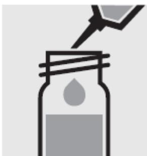
Добавьте 1.0 мл образца с помощью пипетки в реакцию кювету и закройте завинчивающейся крышкой, перемешайте.
