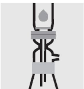
Отфильтруйте **подготовленный раствор** через мембранный фильтр с помощью вакуумной фильтрации в чистую и сухую коническую колбу.
