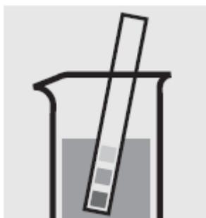
Проверьте pH образца, установленный диапазон: pH 4-13. При необходимости добавьте разведенный раствор гидроксида натрия или серной кислоты по каплям для регулировки значения pH.
