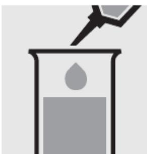
Добавьте с помощью пипетки 0.50 мл образца в тестовую пробирку.
