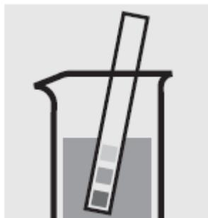
Проверьте pH образца, установленный диапазон: pH 4-10. При необходимости добавьте разведенный раствор гидроксида натрия или серной кислоты по каплям для регулировки значения pH.
