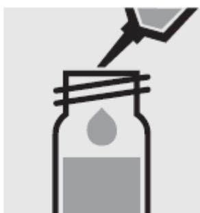
Добавьте 5.0 мл образца с помощью пипетки в реакцию кювету и закройте завинчивающейся крышкой, перемешайте.
