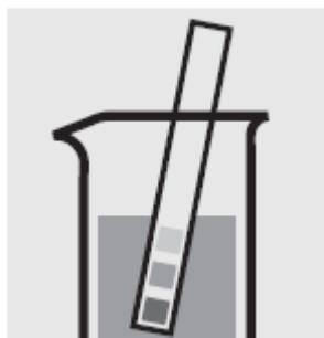
Проверьте pH образца, установленный диапазон: pH 1-12. При необходимости добавьте разведенный раствор серной кислоты по каплям для регулировки значения pH.
