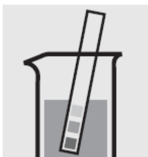
Проверьте pH образца, установленный диапазон: pH 2-12. При необходимости добавьте разведенный раствор гидроксида натрия или азотной кислоты по каплям для регулировки значения pH.
