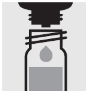
Добавьте 3 капли CN-2, закройте завинчивающейся крышкой и перемешайте: **предварительно подготовленный образец.**
