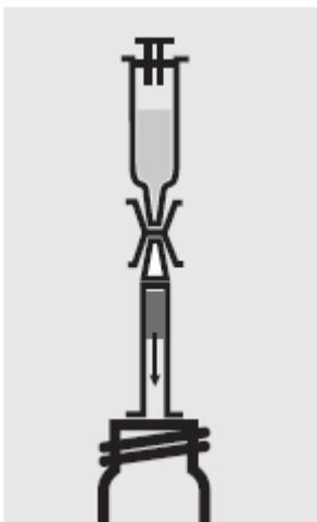
Наполните 10 мл шприц реагентом **АОХ-5** и присоедините шприц к выходному отверстию колонки с помощью коннектора. Поместите верхний конец колонки в пустую кювету, и промойте древесно-угольное наполнение колонки в пустую 16-мм кювету.
