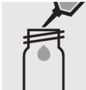
Добавьте 5.0 мл образца с помощью пипетки в реакционную кювету, закройте завинчивающейся крышкой и растворите твердое вещество.
