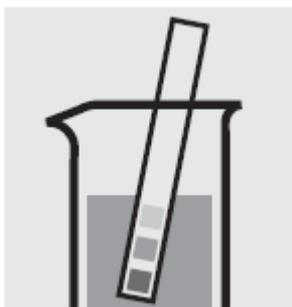
Проверьте pH образца, установленный диапазон: pH 10-12. При необходимости добавьте разведенный раствор гидроксида натрия или серной кислоты по каплям для регулировки значения pH.
