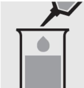
Добавьте с помощью пипетки 0.60 мл **NH<sub>4</sub>-1** (из Spectroquant® Ammonium Test, каталожный номер 114752) и перемешайте.
