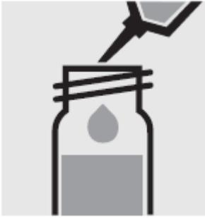
Добавьте **Zn-6** (изобутилметилкетон, каталожный номер 106146) с помощью пипетки и закройте тестовую пробирку завинчивающейся крышкой.
