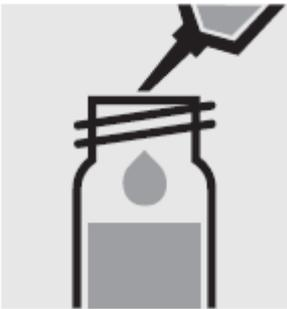
Добавьте с помощью пипетки 1.0 мл образца, закройте завинчивающейся крышкой и перемешайте.
