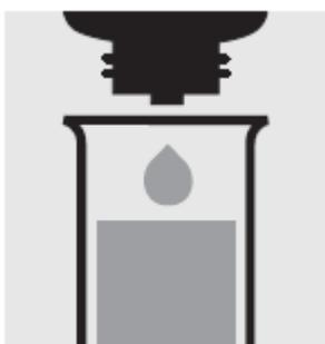
Добавьте 4 капли **NH<sub>4</sub>-3** (из Spectroquant® Ammonium Test, каталожный номер 114752) и перемешайте.
