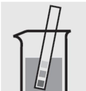
Проверьте pH образца, установленный диапазон: pH 4-8. При необходимости добавьте разведенный раствор гидроксида натрия или серной кислоты по каплям для регулировки значения pH.
