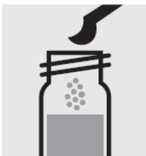
Добавьте 1 синюю микроложку **CN-4**, закройте завинчивающейся крышкой.
