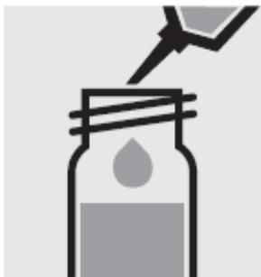
Добавьте 5.0 мл образца с помощью пипетки в тестовую пробирку с завинчивающейся крышкой.
