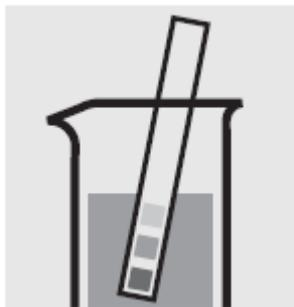
Проверьте pH образца, установленный диапазон: pH 4-10. При необходимости добавьте разведенный раствор гидроксида натрия или соляной кислоты по каплям для регулировки значения pH.
