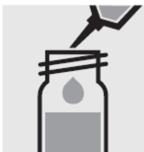
**Осторожно** добавьте 3.0 мл **истощенного образца** с помощью пипетки в реакционную кювету, плотно закройте завинчивающейся крышкой и тщательно перемешайте. **Внимание, кювета нагревается!**
