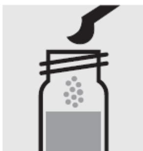
Добавить 1 микроложку **N-3К** в **реакционную кювету**, закройте завинчивающейся крышкой.
