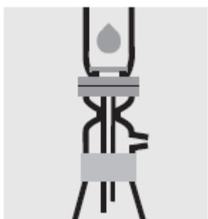
Отфильтруйте **предварительно подготовленный раствор** через мембранный фильтр с помощью вакуумной фильтрации в чистую и сухую коническую колбу.
