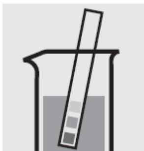
Проверьте pH образца, установленный диапазон: pH 0-13.
