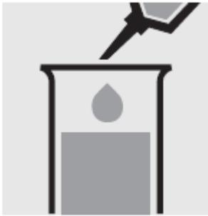
Добавьте в другую пробирку 10 мл дистиллированной воды (рекомендуется вода для анализа EMSURE<sup>®</sup>, каталожный номер 116754) с помощью пипетки и перемешайте (контроль).
