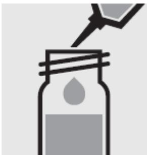
Добавьте 0.20 мл **Oxyscav 2** с помощью пипетки, закройте завинчивающейся крышкой и перемешайте.
