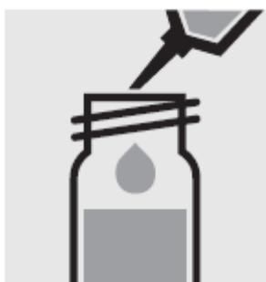
Добавьте с помощью пипетки 10 мл образца в реакционную кювету, закройте кювету завинчивающейся крышкой и перемешайте.
