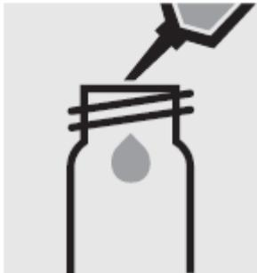
Добавьте с помощью пипетки 5.0 мл **предварительно подготовленного образца** в реакционную кювету, закройте завинчивающейся крышкой и растворите вещество.
