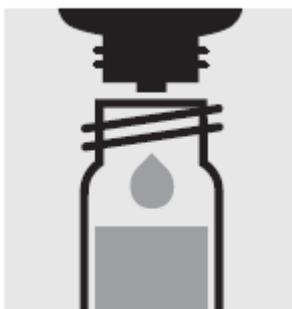
Добавьте 5 капель **Zn-3**, закройте тестовую пробирку завинчивающейся крышкой и перемешайте.
