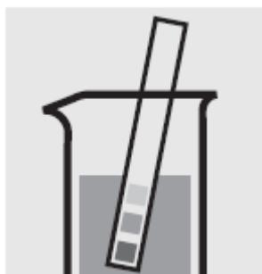
Проверьте pH образца, установленный диапазон: pH 1-7. При необходимости добавьте разведенный раствор гидроксида натрия или соляной кислоты по каплям для регулировки значения pH.
