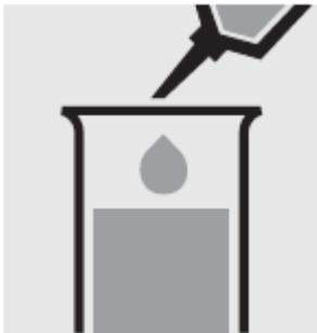
Добавьте с помощью пипетки 10 мл образца в тестовую пробирку.
