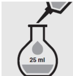
Добавьте с помощью пипетки 4.0 мл образца в 25-мл мерную колбу, наполните до метки дистиллированной водой и тщательно перемешайте.
