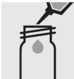
Добавьте с помощью пипетки 5.0 мл образца в пустую тестовую пробирку (например, плоскодонная кювета, каталожный номер 114902).
