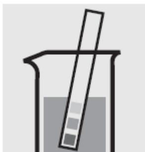
Проверьте pH образца, установленный диапазон: pH 3-11. При необходимости добавьте разведенный раствор гидроксида натрия или серной кислоты по каплям для регулировки значения pH.
