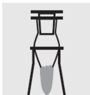
Закройте поглотительные трубки стеклянными пробками, и присоедините в верхней части к колбам Эрленмейера.
