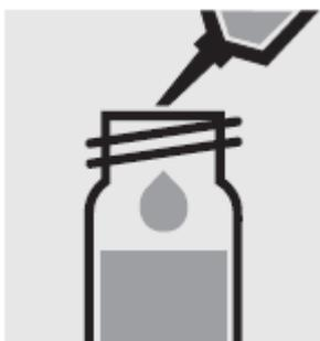
Добавьте 5.0 мл образца с помощью пипетки, закройте кювету завинчивающейся крышкой и перемешайте.
