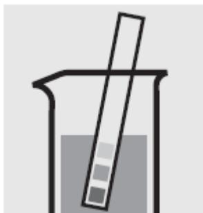
Проверьте pH образца, установленное значение: pH 7.0. При необходимости добавьте разведенный раствор гидроксида натрия или серной кислоты по каплям для регулировки значения pH.
