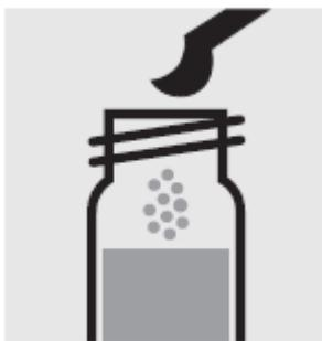
Добавьте 1 микроложку **NO<sub>3</sub>-1К** в реакционную кювету и закройте завинчивающейся крышкой.
