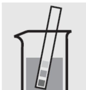
Проверьте рН образца, установленный диапазон: рН 4-8. При необходимости добавьте разведенный раствор гидроксида натрия или серной кислоты по каплям для регулировки значения рН.
