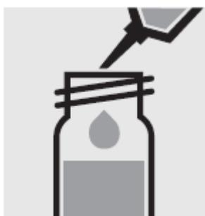
Добавьте 1.0 мл  $\text{NO}_3\text{-1K}$  с помощью пипетки, закройте кювету завинчивающейся крышкой и перемешайте. **Внимание! Кювета нагревается!**
