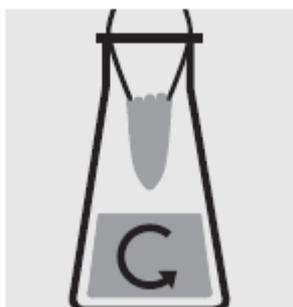
Перемешивайте при 250 об/мин в течение 2 часов при комнатной температуре: истощенный образец/истощенный контрольный образец
