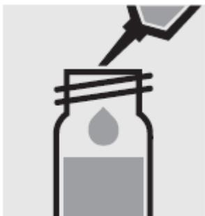
Добавьте 10 мл образца с помощью пипетки в реакционную кювету, закройте завинчивающейся крышкой и перемешайте.
