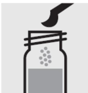
Добавьте 1 синюю микроложку **CN-3K**, закройте завинчивающейся крышкой.
