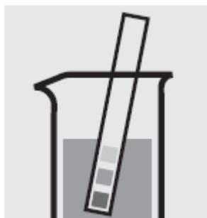
Проверьте pH образца, установленный диапазон: pH 0-13.
