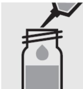
Добавьте 5.0 мл **дистиллированной воды** (рекомендуется использовать воду для анализа EMSURE<sup>®</sup>, каталожный номер 116754) с помощью пипетки, закройте завинчивающейся крышкой и перемешайте.
