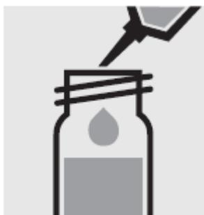
**Осторожно** добавьте 5.0 мл **истощенного контрольного образца** с помощью пипетки во вторую реакционную кювету, плотно закройте завинчивающейся крышкой и тщательно перемешайте. **Внимание, кювета нагревается!** (контрольная кювета)
