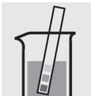
Проверьте pH образца, установленный диапазон: pH 7.0 – 9.5. При необходимости добавьте разведенный раствор гидроксида натрия или серной кислоты по каплям для регулировки значения pH.
