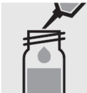
Добавьте 5.0 мл  $\text{NO}_3^-$  с помощью пипетки в кювету. Закройте завинчивающейся крышкой.
