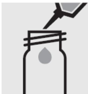
Добавьте с помощью пипетки 5.0 мл **предварительно подготовленного образца** в пустую круглую кювету (пустые кюветы, каталожный номер 114724).
