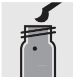
Добавьте с помощью микроложки 1 стеклянную частицу.
