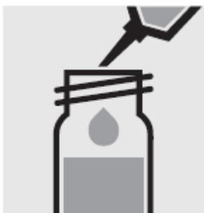
Добавьте 1.0 мл **предварительно подготовленного образца** в реакционную кювету с помощью пипетки, **не перемешивайте!**
