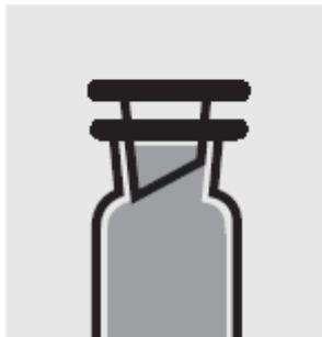
Проинкубируйте одну ёмкость с **предварительно подготовленным образцом** и одну ёмкость с **инокулированным раствором, обогащенным питательными солями** в закрытом виде в термостатической, инкубационной камере при  $20 \pm 1^\circ\text{C}$  в течение 5 дней.
