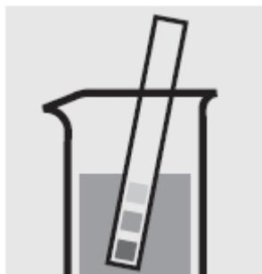
Проверьте рН образца, установленный диапазон: рН 3-10. При необходимости добавьте разведенный раствор гидроксида натрия или серной кислоты по каплям для регулировки значения рН.
