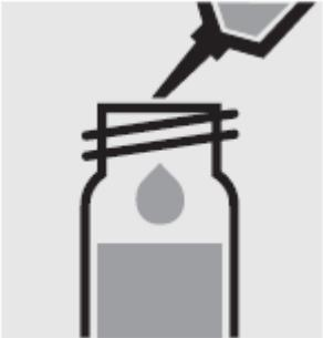
Добавьте с помощью пипетки 5.0 мл образца в тестовую пробирку с завинчивающейся крышкой. (**Важно: не используйте тестовые пробирки из стекла, содержащего бор!**)
