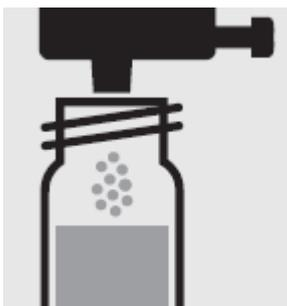
Добавьте 1 дозу **Fe-3** с использованием синего дозиметрического колпачка и растворите твердое вещество.
