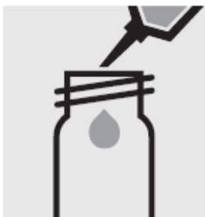
Добавьте 9.0 мл дистиллированной воды (рекомендуется использовать воду для анализа EMSURE<sup>®</sup>, каталожный номер 116754) с помощью пипетки.
