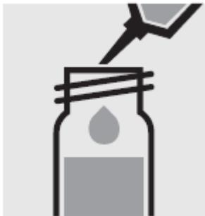
Добавьте 7.0 мл **предварительно подготовленного образца** с помощью стеклянной пипетки, закройте кювету завинчивающейся крышкой и перемешайте.
