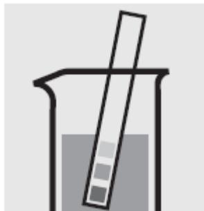
Проверьте общую жесткость образца.
