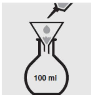
Перенесите образец в 100-мл мерную колбу путем ополаскивания **80** мл **дистиллированной воды** (вода для анализа EMSURE<sup>®</sup>, номер в каталоге 116754).
