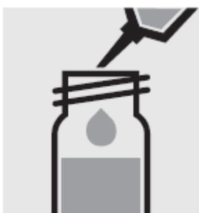
Добавьте 0.50 мл образца с помощью пипетки, закройте кювету завинчивающейся крышкой и перемешайте.
