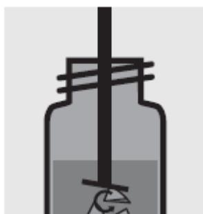
Измельчите фильтр в гомогенизаторе. Ополосните вместе небольшим количеством этанола.
