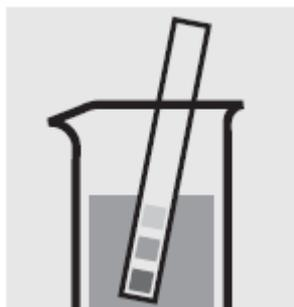
Проверьте pH образца, установленный диапазон: pH 2-7. При необходимости добавьте разведенный раствор гидроксида натрия или серной кислоты по каплям для регулировки значения pH.
