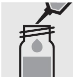
**Осторожно** добавьте 0.10 мл образца с помощью пипетки в реакционную кювету, плотно закройте завинчивающейся крышкой и тщательно перемешайте. **Внимание, кювета нагревается!**
