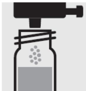
Добавьте 1 дозу **Cr-2К**, с использованием синего дозиметрического колпачка, закройте реакционную кювету завинчивающейся крышкой.
