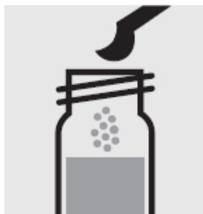
Добавьте 1 синюю микроложку **Cl<sub>2</sub>-1**, закройте завинчивающейся крышкой.
