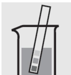
Проверьте pH образца, установленный диапазон: pH 1-10. При необходимости добавьте разведенный раствор гидроксида натрия или соляной кислоты по каплям для регулировки значения pH.
