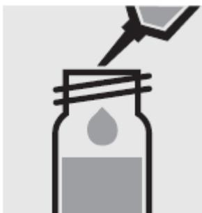
Добавьте 10 мл образца с помощью пипетки, закройте кювету завинчивающейся крышкой.
