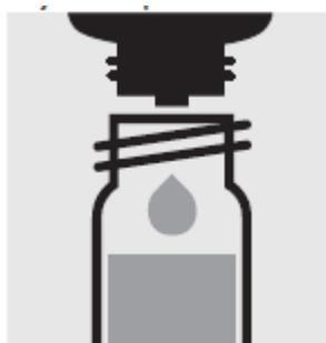
Добавьте 5 капель **Zn-1**, закройте тестовую пробирку завинчивающейся крышкой и перемешайте.
