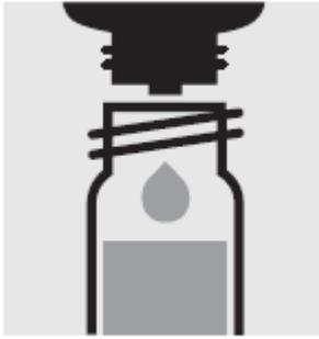
Добавьте 3 капли **CN-2К**, закройте завинчивающейся крышкой и перемешайте: **предварительно подготовленный образец.**
