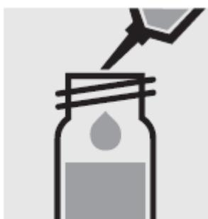
**Осторожно** добавьте 2.0 мл образца с помощью пипетки в реакцию кювету, плотно закройте завинчивающейся крышкой и тщательно перемешайте. **Внимание, кювета нагревается!**
