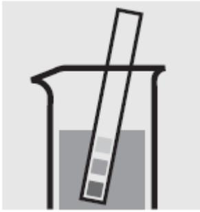
Проверьте pH образца, установленный диапазон: pH 3-7. При необходимости добавьте разведенный раствор гидроксида натрия или уксусной кислоты по каплям для регулировки значения pH.
