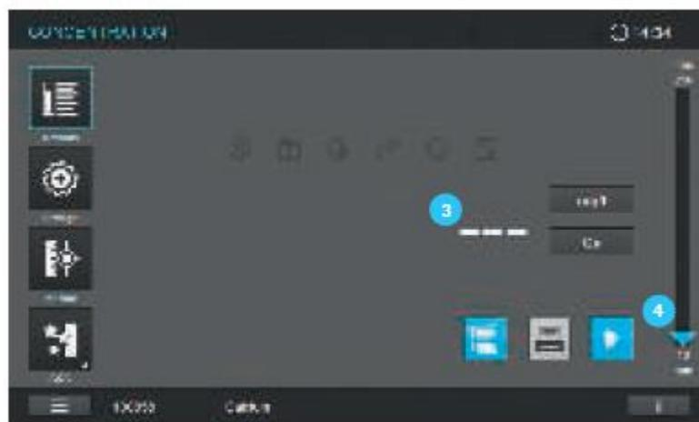
Если результат измерения превышает верхнюю и нижнюю границу диапазона измерения, результат не отображается.
