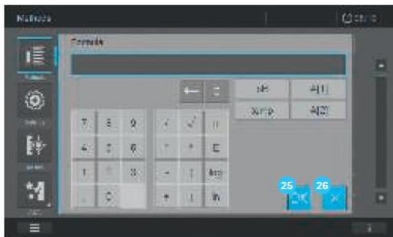
11. При нажатии на кнопку ОК <sup>25</sup> принимаются введенные значения. При нажатии на кнопку X <sup>26</sup> экран закрывается и открывается предыдущее поле ввода.
