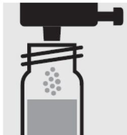
Добавьте 1 дозу **CN-1K** с помощью зеленого дозирующего колпачка, закройте кювету завинчивающимся колпачком.
