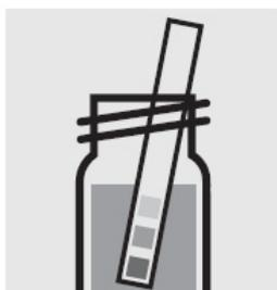
Проверьте pH образца, нужное значение: pH 2,0 – 2,5. Если нужно, добавьте разбавленный раствор гидроксида натрия или по капле серную кислоту для регулировки pH.
