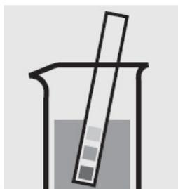
Проверьте pH образца, нужное значение: pH 2 – 10. Если нужно, добавьте разбавленный раствор гидроксида натрия или по капле соляную кислоту для регулировки pH.
