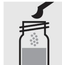
Добавьте 1 синюю микроложечку без горки Cl<sub>2</sub>-1, закройте завинчивающимся колпачком.
