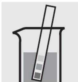
Проверьте pH образца, нужное значение: pH 0 – 10. Если нужно, добавьте по капле разбавленную серную кислоту для регулировки pH.
