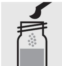
Добавьте 1 зеленую микроложечку без горки SO<sub>4</sub>-1K, закройте завинчивающимся колпачком.
