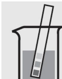
Проверьте pH образца, нужное значение: pH 0 – 10. Если нужно, добавьте по капле разбавленную серную кислоту для регулировки pH.
