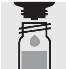
Добавьте 3 капли **CN-2K**, закройте завинчивающимся колпачком и перемешайте: **обработанный образец**.
