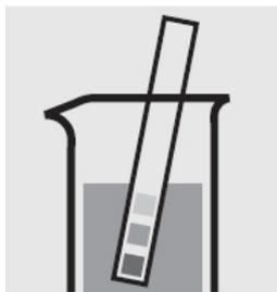
Проверьте pH образца, нужное значение: pH 4 - 8. Если нужно, добавьте разбавленный раствор гидроксида натрия или по капле серную кислоту для регулировки pH.
