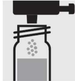
Добавьте 1 дозу P-1К с помощью зеленого дозирующего колпачка, закройте кювету завинчивающимся колпачком и перемешайте.
