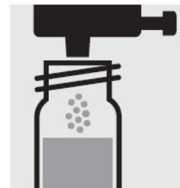
Добавьте синим колпачком-дозатором по 1 дозе  **$\text{NH}_4\text{-1K}$**  в каждую кювету, закройте завинчивающимся колпачком.
