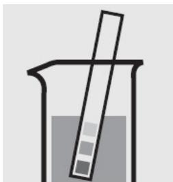
Проверьте pH образца, нужное значение: pH 2 - 8. Если нужно, добавьте разбавленный раствор гидроксида натрия или по капле азотную кислоту для регулировки pH.
