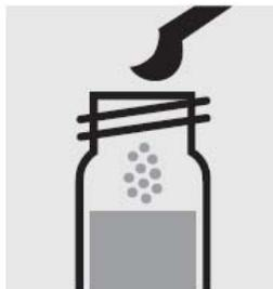
Добавьте по 1 серой микроложечке без горки SO<sub>3</sub>-1K в две кюветы для реакции, закройте завинчивающимися колпачками.
