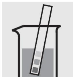
Проверьте pH образца, нужное значение: pH 3 - 11. Если нужно, добавьте разбавленный раствор гидроксида натрия или по капле серную кислоту для регулировки pH.
