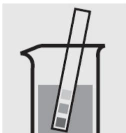
Проверьте pH образца, нужное значение: pH 1 - 10. Если нужно, добавьте разбавленный раствор гидроксида натрия или по капле соляную кислоту для регулировки pH.
