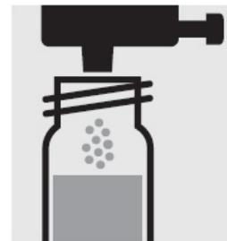
Добавьте в каждую кювету по 1 дозе F-1К с помощью синего дозирующего колпачка, закройте завинчивающимся колпачком.
