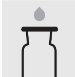
Заполните до краев 2 колбы для реакции с кислородом **обработанным образцом** и 2 стеклянными шариками. Закройте без пузырьков скошенными стеклянными притертыми пробками.
