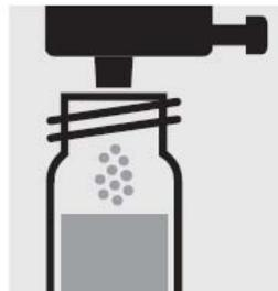
Добавьте 1 дозу Cr-2K с помощью синего колпачка-дозатора, закройте кювету для реакции заворачивающимся колпачком.
