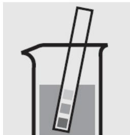
Проверьте pH образца, нужное значение: pH 2 – 11. Если нужно, добавьте разбавленный раствор гидроксида натрия или по капле серную кислоту для регулировки pH.
