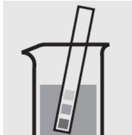
Проверьте pH образца, нужное значение: pH 6 - 8. Если нужно, добавьте разбавленный раствор гидроксида натрия или по капле серную кислоту для регулировки pH.
