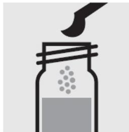
Добавьте 1 синюю микроложечку без горки  $\text{ClO}_2$ -2, закройте завинчивающимся колпачком.
