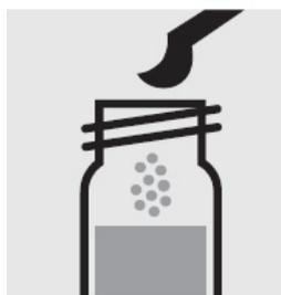
Добавьте 2 синие микроложечки без горки PO<sub>4</sub>-2, закройте кювету заворачивающимся колпачком.
