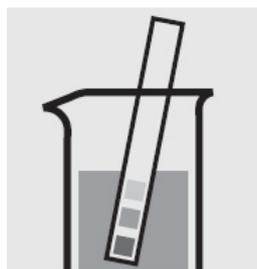
Проверьте pH образца, нужное значение: pH 4 - 8. Если нужно, добавьте разбавленный раствор гидроксида натрия по капле серную кислоту для регулировки pH.
