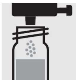
Добавьте 1 дозу P-3K с помощью синего дозирующего колпачка, закройте кювету завинчивающимся колпачком.
