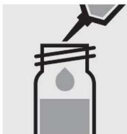
Добавьте в одну кювету пипеткой 2,0 мл **обработанного образца**, закройте завинчивающимся колпачком и перемешайте.
