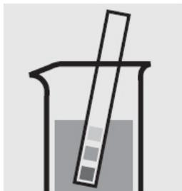
Проверьте pH образца, нужное значение: pH 3 - 10. Если нужно, добавьте разбавленный раствор гидроксида натрия или по капле серную кислоту для регулировки pH.
