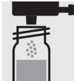
Добавьте 1 дозу P-1К с помощью зеленого дозирующего колпачка, закройте кювету заворачивающимся колпачком и перемешайте.
