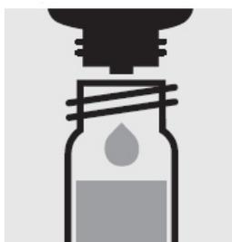
Добавьте 2 капли **Ni-1K**, закройте завинчивающимся колпачком и перемешайте. Проверьте pH раствора, нужное значение: pH 10 - 12.
