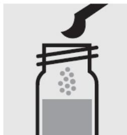
Добавьте по 1 желтой микроложечке без горки **N-3К** в две кюветы для реакции, закройте завинчивающимися колпачками.
