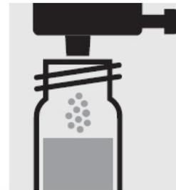
Добавьте 1 дозу **P-3К** с помощью синего дозирующего колпачка, закройте кювету завинчивающимся колпачком.
