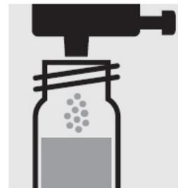
Добавьте синий колпачком-дозатором по 1 дозе  $\text{NH}_4\text{-1K}$  в каждую кювету, закройте завинчивающимся колпачком.
