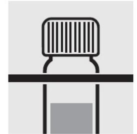
Выньте кювету из термореактора и поместите ее в стойку для пробирок для охлаждения до комнатной температуры.
