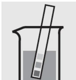
Проверьте pH образца, нужное значение: pH 1 - 9. Если нужно, добавьте разбавленный раствор гидроксида натрия или по капле серную кислоту для регулировки pH.
