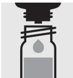
Добавьте 4 капли **Mn-2**, закройте завинчивающимся колпачком и перемешайте. Проверьте pH, нужное значение pH: примерно 11,5.
