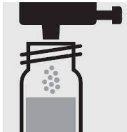
Добавьте 1 дозу PO<sub>4</sub>-2 с помощью синего дозирующего колпачка, закройте кювету завинчивающимся колпачком.
