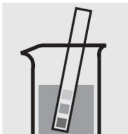
Проверьте pH образца, нужное значение: pH 3 - 6. Если нужно, добавьте разбавленный раствор аммиака или по капле азотную кислоту для регулировки pH.
