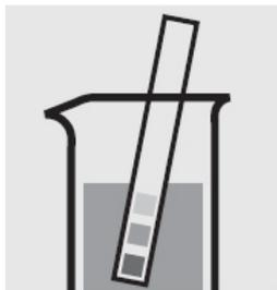
Проверьте pH образца, нужное значение: pH 2 - 7. Если нужно, добавьте разбавленный раствор гидроксида натрия или по капле серную кислоту для регулировки pH.
