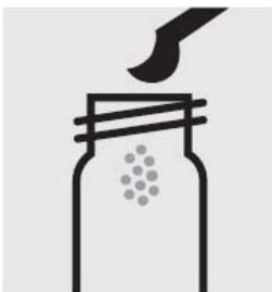
Насыпьте по 1 синей микроложечке  $\text{NO}_3\text{-1}$  в две сухие 16-мм кюветы.
