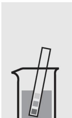
Проверьте pH образца, нужное значение: pH 6 - 7. При необходимости добавьте разбавленный раствор гидроксида натрия или по каплям азотную кислоту для регулировки pH.
