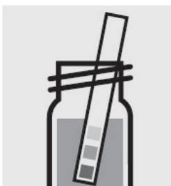
Проверьте pH образца, нужное значение: pH 10 - 12.
