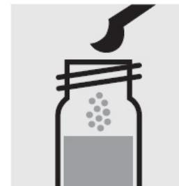
Добавьте 1 синюю микроложечку без горки  $\text{Cl}_2$ -1, закройте завинчивающимся колпачком.
