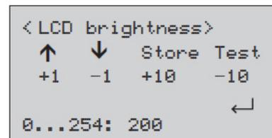
При нажатии клавиши **[▲]** яркость ЖК-дисплея повышается примерно на одну единицу.
