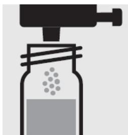
Добавьте 1 дозу P-2K с помощью синего дозирующего колпачка, закройте кювету завинчивающимся колпачком.
