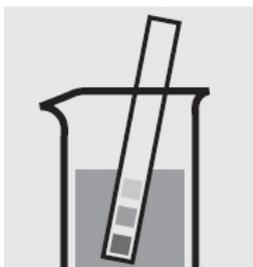
Проверьте pH образца, нужное значение: pH 2 - 10. Если нужно, добавьте разбавленный раствор гидроксида натрия или по капле серную кислоту для регулировки pH.
