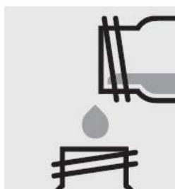
Перенесите измеряемый образец в 24-мм кювету, закройте завинчивающимся колпачком и замеряйте **немедленно**.
