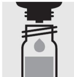
Добавьте 3 капли CN-2, закройте завинчивающимся колпачком и перемешайте: **обработанный образец.**
