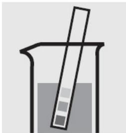
Проверьте pH образца, нужное значение: pH 3 - 8. Если нужно, добавьте разбавленный раствор гидроксида натрия или по капле серную кислоту для регулировки pH.
