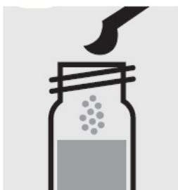
Добавьте в каждую кювету по 1 зеленой микроложечке без горки  $\text{SO}_4\text{-2}$ , закройте завинчивающимся колпачком.
