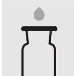
Заполните до краев 2 колбы для реакции с кислородом **инокулированным питательно-солевым раствором** и 2 стеклянными шариками. Закройте без пузырьков скошенными стеклянными притертыми пробками.
