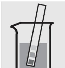
Проверьте pH образца, нужное значение: pH 4,5 - 8. Если нужно, добавьте разбавленный раствор гидроксида натрия или по капле серную кислоту для регулировки pH.
