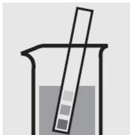
Проверьте pH образца, нужное значение: pH 4 - 13. Если нужно, добавьте разбавленный раствор гидроксида натрия или по капле серную кислоту для регулировки pH.
