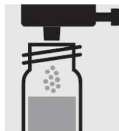
Добавьте 1 дозу P-3К с помощью синего дозирующего колпачка, закройте кювету заворачивающимся колпачком.
