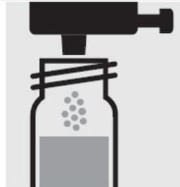
Добавьте 1 дозу CN-1 с помощью зеленого дозирующего колпачка, закройте кювету завинчивающимся колпачком.
