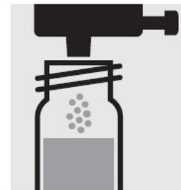
Добавьте в каждую кювету по 1 дозе F-1K с помощью синего дозирующего колпачка, закройте завинчивающимся колпачком.
